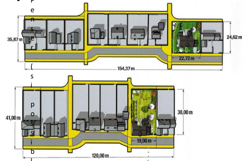
Ci-dessus : illustration schématique d'une économie de voie par une réflexion sur la largeur de parcelle sans impacter le cadre de vie (CAUE 53).
